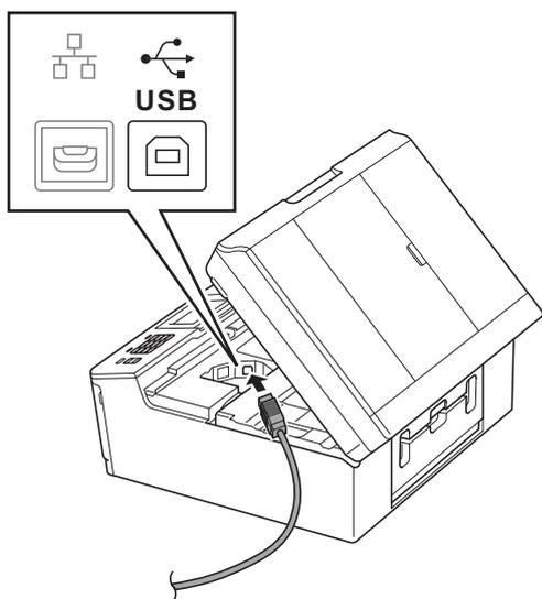
**c** 小心地将 USB 接口电缆嵌入电缆槽内并沿着凹槽绕到设备后部，然后将接口电缆连接到计算机。
