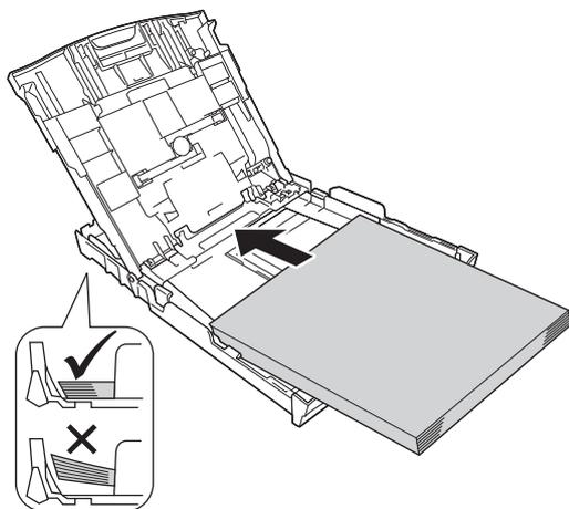
**f** 用双手轻轻滑动纸张宽度导块，调整至纸张尺寸。确保纸张宽度导块触碰到纸张的两边。
