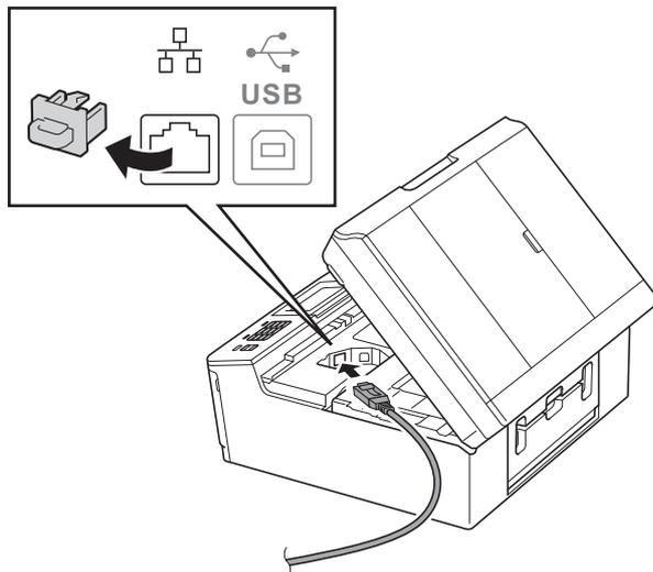
**c** 小心地将网络接口电缆嵌入电缆槽内并沿着凹槽绕到设备后部，然后将接口电缆连接到网络。
