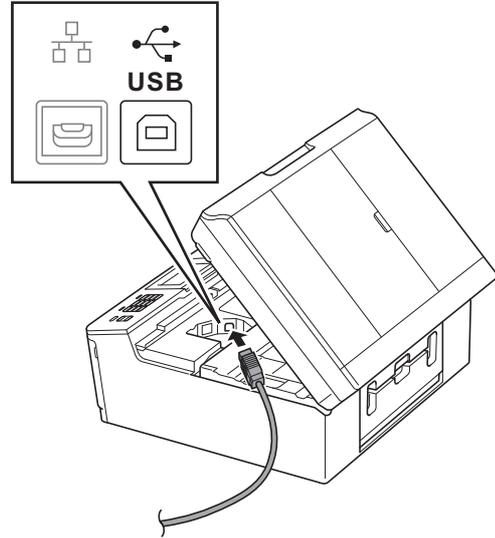
**c** 小心地将 USB 接口电缆嵌入电缆槽内并沿着凹槽绕到设备后部，然后将接口电缆连接到 Macintosh。
