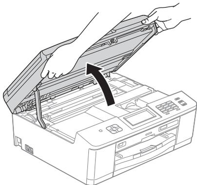
**b** 将 USB 接口电缆一端插入标有
