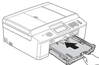
**i** 将纸盒装入到位的同时，拉出纸张支撑板 ① 直至其卡入到位，然后展开纸张支撑翼板 ②。
