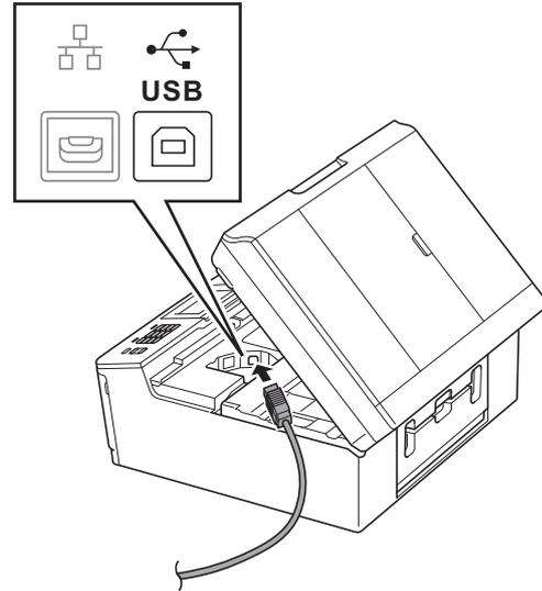
**c** 小心地將 USB 線穿過溝槽，並沿著溝槽將 USB 線繞到設備後面，然後插入您的 Macintosh。
