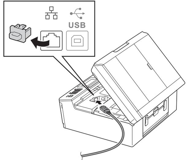
**c** 小心地將網路連接線穿過溝槽，並沿著溝槽將網路連接線繞到設備後面，然後插入您的網路連接埠。
