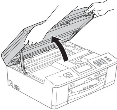
**b** 將 USB 線插入標註有
