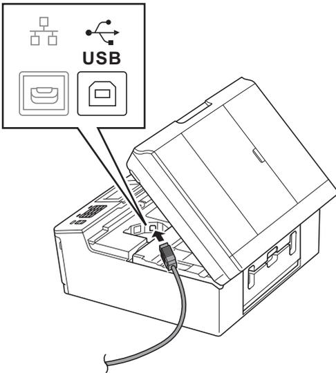
**c** 小心地將 USB 線穿過溝槽，並沿著溝槽將 USB 線繞到設備後面，然後插入您的電腦。
