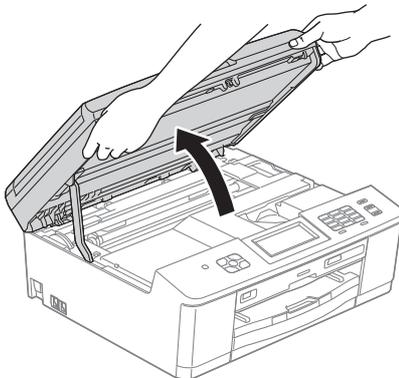
**b** 乙太網路連接埠位於設備內部的左側，標註有
