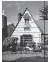
Wenn der Glasstreifen verschmutzt ist, ist eine vertikale Linie im Ausdruck zu sehen.
