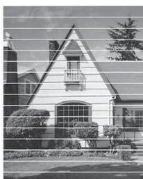
Lorsqu'une buse de la tête d'impression est encrassée, l'échantillon imprimé se présente comme ci-dessus.
