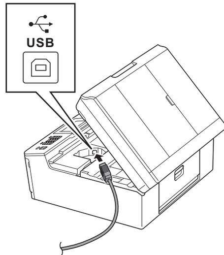
**c** Guidez soigneusement le câble USB dans la rainure spéciale en le faisant sortir par l'arrière de l'appareil. Connectez le câble au Macintosh.
