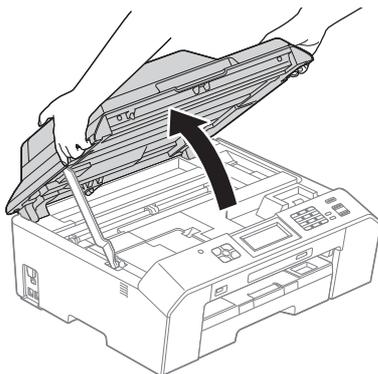
**b** Conecte el cable USB al puerto USB marcado con el símbolo . Encontrará el puerto USB a la derecha en el interior del equipo, como se muestra a continuación.
