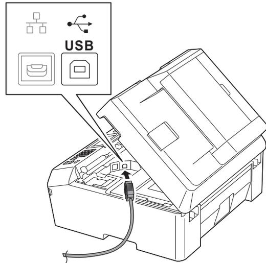
**c** Inserte con cuidado el cable USB en el canal de cables hacia la parte trasera del equipo. Conecte el cable al Macintosh.
