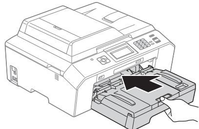
**i** 將紙匣完全推入設備後，拉出紙張支撐板 ① 直到發出卡嗒聲，然後展開紙張支撐翼板 ②。
