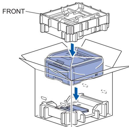
**k** Placez le cordon d'alimentation, le tambour et les cartouches de toner dans l'élément Styrofoam, comme indiqué dans l'illustration.
