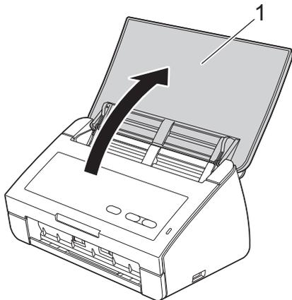
**c** 拉出設備的出紙托板，然後展開原稿擋板。
