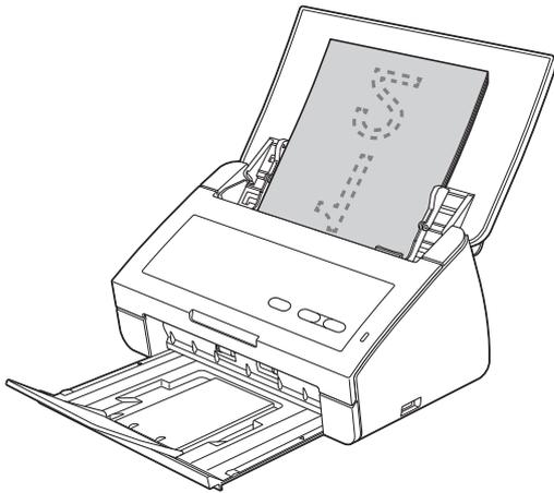
**c** 按**掃描到 PC** 鍵。設備開始送入並掃描文件。掃描的資料將以 PDF 格式儲存到透過 USB 介面電纜連接到設備的電腦上。
