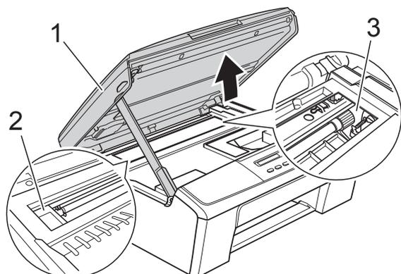
移動列印頭 (如有需要)，以取出該區域中的殘餘紙張。確保設備內部角落 (2) 和 (3) 處沒有遺留卡住的紙張。
