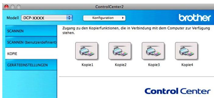
Bevor die **Kopie**-Schaltflächen verwendet werden können, müssen Sie den Druckertreiber entsprechend konfigurieren, indem Sie bei gedrückter **Strg**-Taste auf die Schaltfläche klicken.
