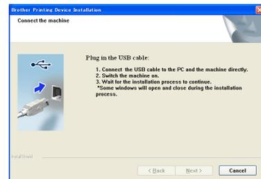
**e** Hubungkan kabel USB ke port USB yang ditandai dengan simbol
