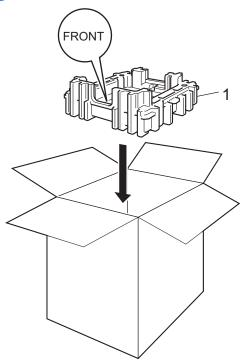
4 Enveloppez l'appareil dans un sac en plastique, puis placez-la sur le matériau d'emballage situé au fond du carton(1).
