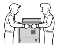
NE transportez PAS l'appareil avec le bac inférieur, au risque de vous blesser ou d'endommager l'appareil, car il n'est pas fixé à ce dernier.
