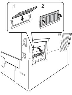
6 Remettez en place le capot en plastique du module SO-DIMM (1).
