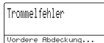
Der Koronadraht ist verschmutzt. Reinigen Sie den Koronadraht in der Trommeleinheit. (Siehe *Koronadraht reinigen* >> Seite 88.)
