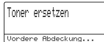
Das Gerät stoppt den Druckvorgang, bis Sie die Tonerkassette ausgetauscht haben. Das Einsetzen einer neuen Brother Original-Tonerkassette behebt die Meldung für den Toner-ersetzen-Fehler.
