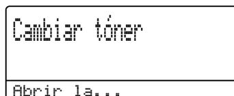
El equipo detendrá la impresión hasta que se sustituya el cartucho de tóner. Al introducir un cartucho de tóner nuevo original de Brother desaparecerá el mensaje `Cambie tóner.`
