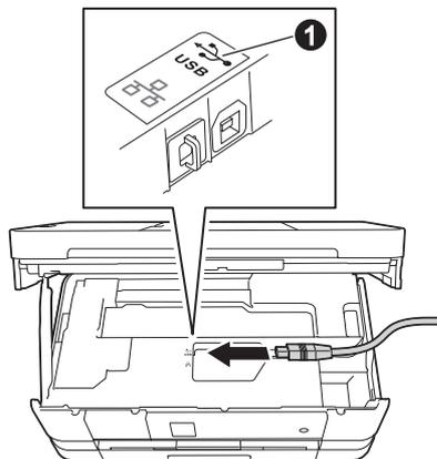
**c** Prestando la dovuta attenzione, far passare il cavo USB nell'apposita canalina fino all'uscita sul retro dell'apparecchio. Collegare il cavo al Macintosh.
