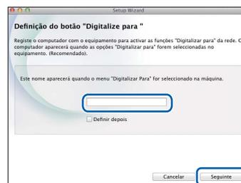
O nome que introduzir aparecerá no LCD do equipamento quando seleccionar uma opção de digitalização. (►► Manual do Utilizador: Digitalizar a partir do painel de controlo do equipamento)
