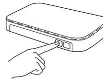
При нажатии кнопки **OK** устройство автоматически определит, какой режим (WPS или AOSS™) используется беспроводной точкой доступа/маршрутизатором, и попытается подключиться к беспроводной сети.
