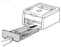
Mientras presiona la palanca verde de desbloqueo de las guías del papel ①, deslice las guías del papel para ajustarlas al tamaño del papel que esté cargando en la bandeja. Asegúrese de que las guías estén correctamente encajadas en las ranuras.
