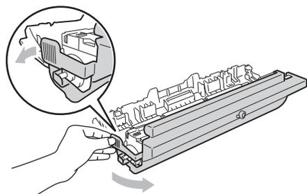
7 Insérez fermement la cartouche de toner dans la nouvelle unité de tambour jusqu'à ce que le déclic de verrouillage se fasse entendre. Si vous avez inséré la cartouche correctement, le levier de verrouillage vert se soulèvera automatiquement.
