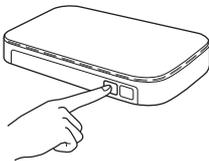
Mit dieser Funktion wird automatisch ermittelt, welches Verfahren (WPS oder AOSS™) Ihr Wireless-Access Point/Router zur Konfiguration Ihres Geräts verwendet.
