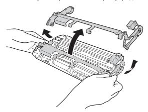
Возьмите двумя руками каждый блок фотобарабана и тонер-картриджа и осторожно встряхните его несколько раз из стороны в сторону, чтобы тонер равномерно распределился внутри узла.
