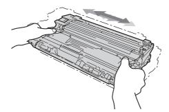
Вставьте все четыре блока фотобарабанов и тонер-картриджей в аппарат. Убедитесь, что цвет тонер-картриджа совпадает с цветом наклейки на аппарате.
