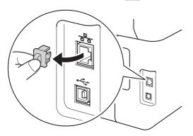
Подключите кабель сетевого интерфейса к порту Ethernet на аппарате, затем подсоедините его к свободному порту сетевого концентратора.
