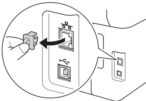
**c** Conecte el cable de interfaz de red al puerto Ethernet del equipo y, a continuación, conéctelo a un puerto libre del concentrador.
