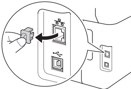
**c** 將網路傳輸線一端插入機器上的乙太網路連接埠，另一端插入集線器的空閒連接埠。
