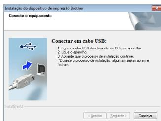
**e** Ligue o cabo USB na porta USB marcada com o símbolo
