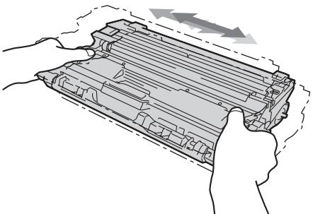
**h** Вставьте все четыре блока фотобарабанов и тонер-картриджей в аппарат. Убедитесь, что цвет тонер-картриджа совпадает с цветом наклейки на аппарате.
