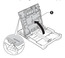
Pressione ligeiramente e faça deslizar as guias da largura do papel • e, em seguida, a guia do comprimento do papel • de forma a ajustá-las ao tamanho do papel.
