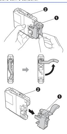
Tenha o cuidado de fazer corresponder a cor do autocolante to com a cor do cartucho , conforme ilustrado na figura. Instale cada cartucho de tinta no sentido da seta existente na etiqueta.
