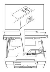
Passe cuidadosamente o cabo USB através da calha e para fora da parte de trás do equipamento. Ligue o cabo ao Macintosh.
