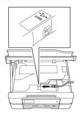
C Passe cuidadosamente o cabo USB através da calha e para fora da parte de trás do equipamento. Ligue o cabo ao computador.
