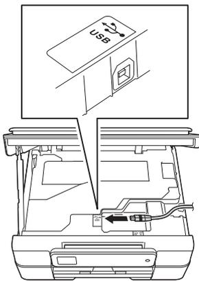
**c** Guidez soigneusement le câble USB dans la rainure spéciale en le faisant sortir par l'arrière de l'appareil. Connectez le câble à l'ordinateur.
