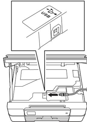
**c** Guidez soigneusement le câble USB dans la rainure spéciale en le faisant sortir par l'arrière de l'appareil. Connectez le câble au Macintosh.
