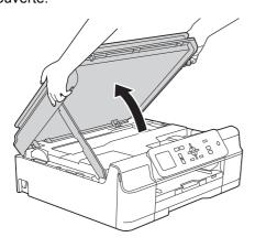
Connectez le câble USB au port USB repéré par un symbole . Vous trouverez le port USB à l'intérieur de l'appareil comme illustré cidessous.
