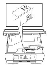
C Guidez soigneusement le câble USB dans la rainure spéciale en le faisant sortir par l'arrière de l'appareil. Connectez le câble à l'ordinateur.
