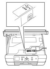
Guidez soigneusement le câble USB dans la rainure spéciale en le faisant sortir par l'arrière de l'appareil. Connectez le câble au Macintosh.
