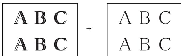
Quando l'allineamento di stampa non è regolato correttamente, il testo appare sfocato come in questo esempio.
