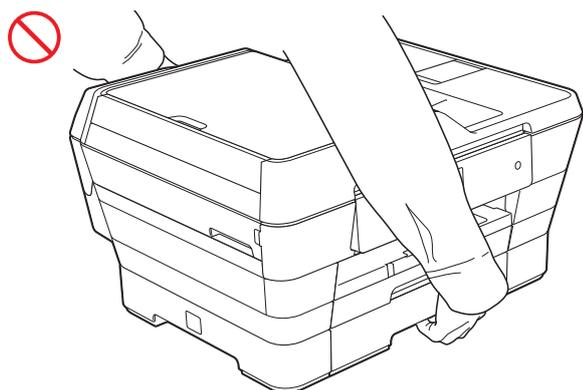
Carregue o aparelho deslizando as mãos até os pontos de apoio localizados nas laterais do aparelho.
