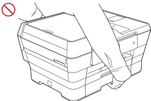
Transportez l'appareil en glissant les mains dans les poignées situées de part et d'autre de l'appareil.
