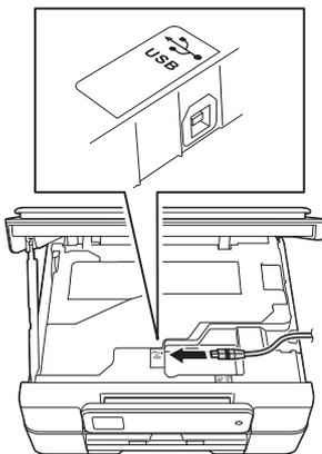
**c** Führen Sie das USB-Kabel vorsichtig durch den Kabelkanal bis zur Rückseite des Gerätes. Schließen Sie das Kabel an Ihren Computer an.
