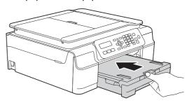
Con la bandeja de papel sujeta en posición cerrada, extraiga el soporte del papel ① hasta que este quede ajustado y, a continuación, despliegue la lengüeta de soporte del papel ②.
