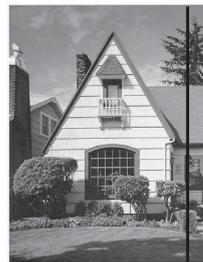
Si hay suciedad o corrector líquido en la banda del cristal, en la prueba de impresión aparecerá una línea vertical.
