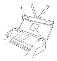
3 Coloque o documento, virado para baixo e com a margem superior primeiro no alimentador de documentos, entre as guias, até o sentir tocar no interior do equipamento.
