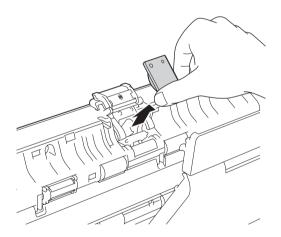
Instale uma nova almofada de separação.
