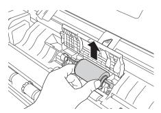
Coloque um novo rolo de recolha no equipamento.
