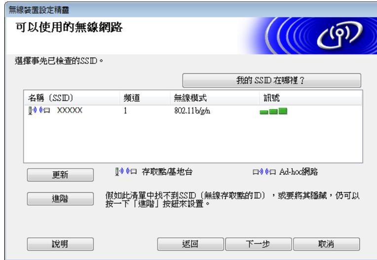
7 在名稱 (SSID) 欄位中，輸入新的 SSID，然後選中該核取方塊。按一下通道下拉清單，選擇您需要的通道，然後按一下下一步。
