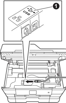
**c** 小心地将 USB 接口电缆嵌入电缆槽内并沿着凹槽绕到设备后部，然后将接口电缆连接到 Macintosh。
