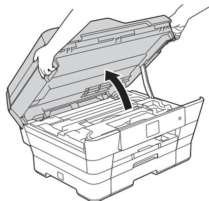
**b** 将网络接口电缆连接到标有
