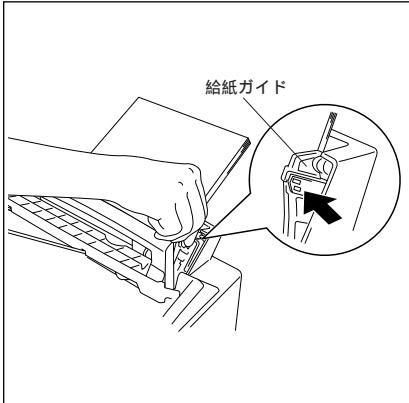
**4** 記録紙の幅に給紙ガイドを合わせます。給紙ガイドは図の矢印で示した部分をつまみながら動かします。
