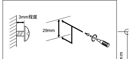
**2** 充電器の壁掛け用の穴をネジにはめ込み、充電器を壁に取り付けます。
