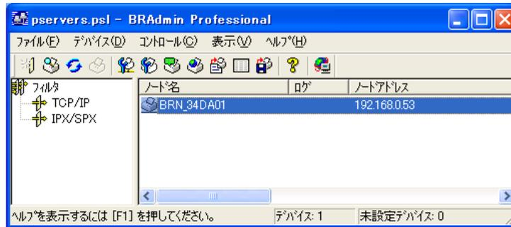
BRAdmin Professional では、本機との接続に TCP/IP を使用して、IP アドレスを変更できます。本機の初期設定の IP アドレスが、使用しているネットワークでの IP アドレス設定規則に適していない場合は、IP アドレスを変更してください。
