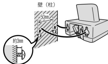
③ACアダプタをコンセントに差し込み、子機を充電器にセットする
