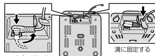
②ACアダプタをコンセントに差し込み、子機を充電器にセットする
