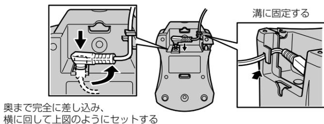
② ACアダプタをコンセントに差し込み、子機を充電器にセットする
