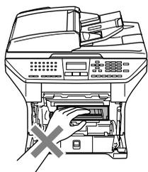
■本製品の内部を操作するときは、以下の図で矢印で示す電極部分には手で触れないでください。静電気で本製品が破損することがあります。
