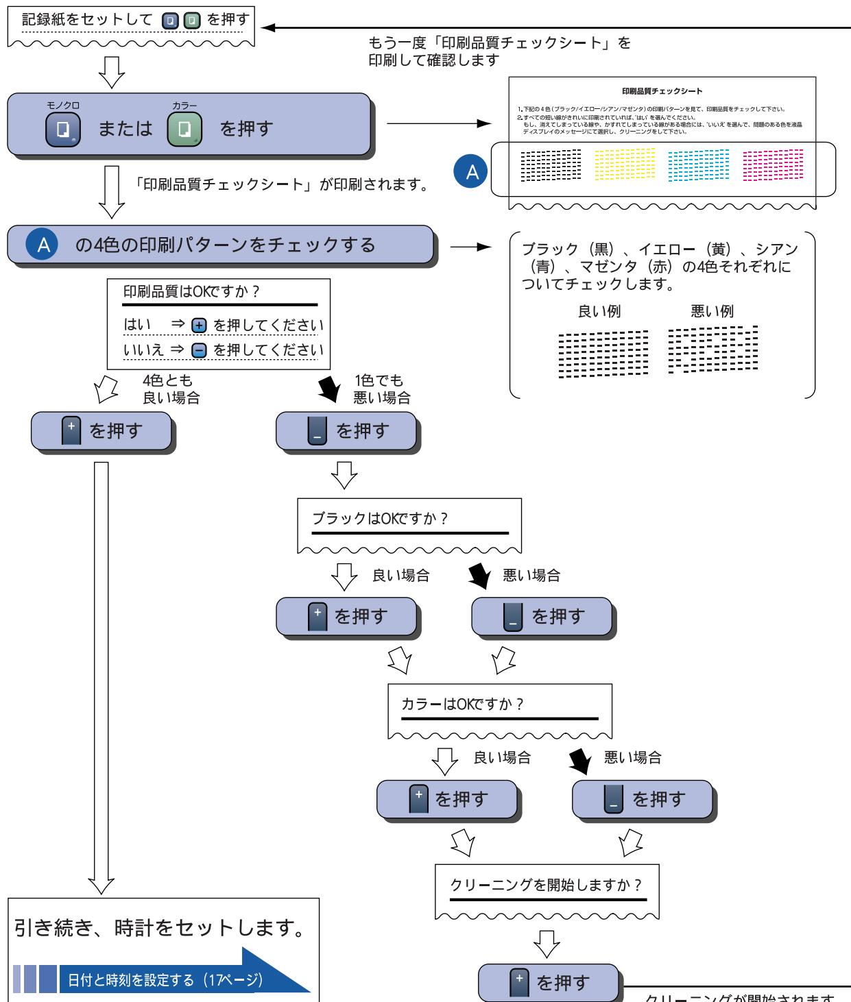
クリーニングを繰り返しても印字品質が悪い場合は、3～5時間放置した後で、再度「印刷品質チェックシート」を印刷してみてください。
