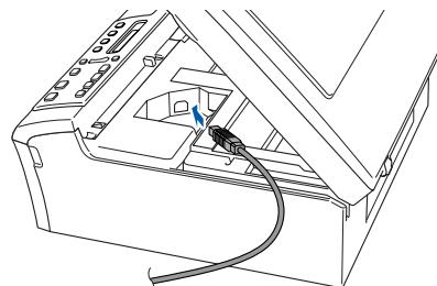
(3) USB ケーブルを本製品の溝におさめ、パソコンに USB ケーブルを接続する
