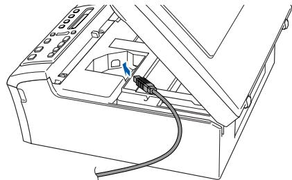
(3) USBケーブルを本製品の溝におさめ、Macintosh®にUSBケーブルを接続する
