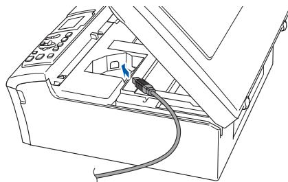
(3) USBケーブルを本製品の溝におさめ、Macintosh®にUSBケーブルを接続する
