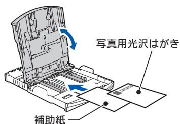
**6** 写真用光沢はがきの先端がコツンと当たるところまで入れ、幅と長さのガイドを写真用光沢はがきに合わせて調節する
