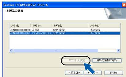
画面の IP アドレス欄に APIPA と表示された場合は、[IP アドレス設定] をクリックし、お使いのネットワーク上での本製品の IP アドレスを入力します。
