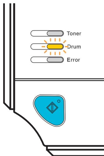
このメッセージが表示されたときは、ドラムユニットの寿命が少なくなっていることを示します。印刷品質が劣化する恐れがあるので、お早めにドラムユニットを交換されることをおすすめします。「ドラムユニットを交換する」[P.5-11](#) を参照してください。
