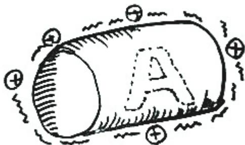
このドラムに、帯電させたトナーを近づけると、ドラム上の電圧の低い部分(絵や文字になる部分)にトナーが移動します。これを「現像」と呼びます。(実際には、トナーが載っているローラーとドラムが接触していて、ローラーとドラムの電位差によりトナーが移動します。)
