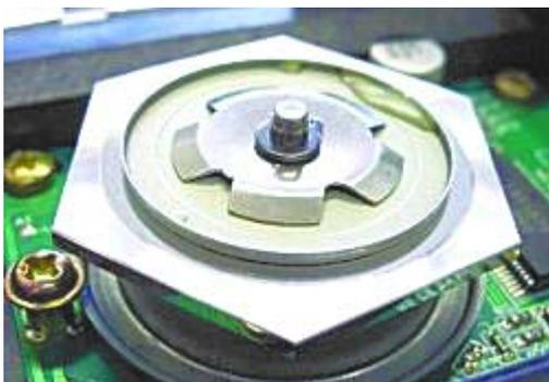
ポリゴンミラーが高速回転することで、光源から放たれたレーザービームを様々な方向へ照射することができます。ポリゴンミラーの働きによって、HL-2140(HL-2170W)のような小さなプリンタ内でもドラムの左右方向へレーザービームを照射することができます。
