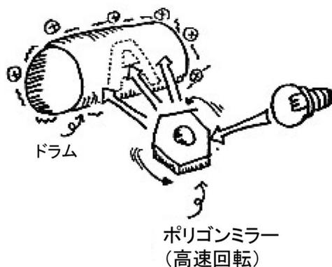
**メモ** レーザープリンタでは、ポリゴンミラーの他にレンズも使用しています。このためレンズやミラーをいくつも使用しているカメラなどと同様に、光学技術を駆使した精密機械であるといえます。
